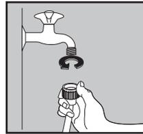
**Cuando hay una válvula de entrada en la parte trasera de la máquina, debe estar conectada a un suministro de agua fría.**
